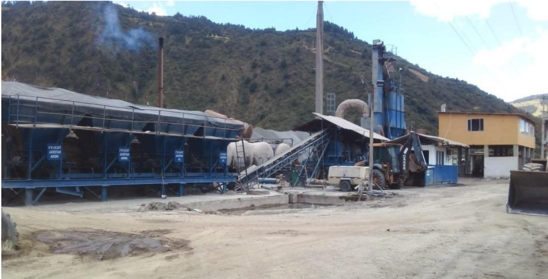
*Nota:* En esta área es donde se produce el asfalto, el cual se utiliza para la construcción de vías.
