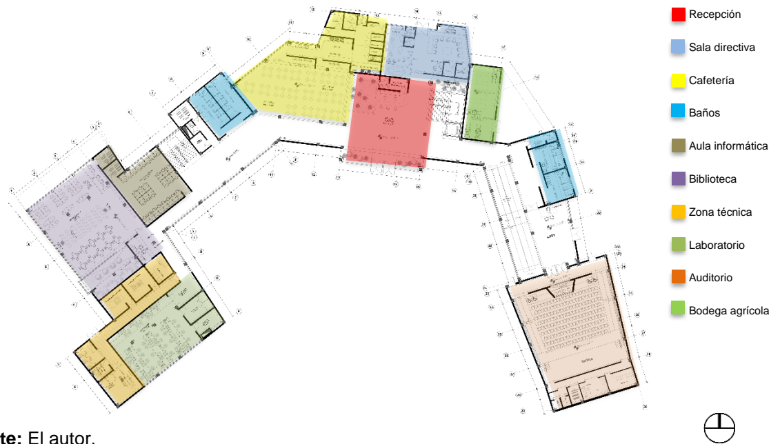
Figura 34. Zonificación primer piso.
