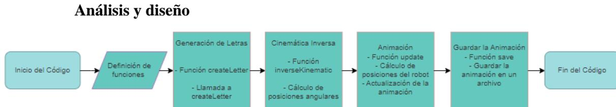
*Figura 8. Diagrama de Flujo Simulación Brazo robótico.*
