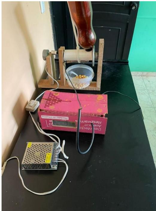
**Figura 21.** Tornillo transportador y electrodo.
