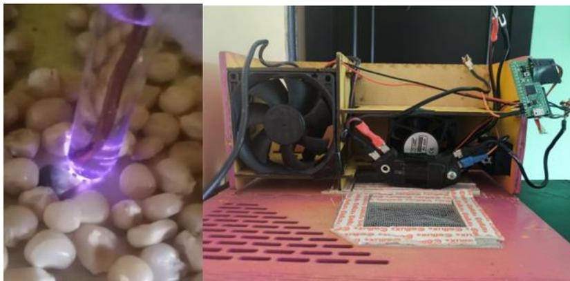
La utilización de plasma frío para desinfectar las semillas de maíz ofrece una alternativa prometedora a los métodos convencionales que a menudo emplean productos químicos que pueden ser perjudiciales. Por otro lado, el acople de impedancias permite mejorar la eficacia del sistema al asegurar una transferencia de energía uniforme y controlada.
