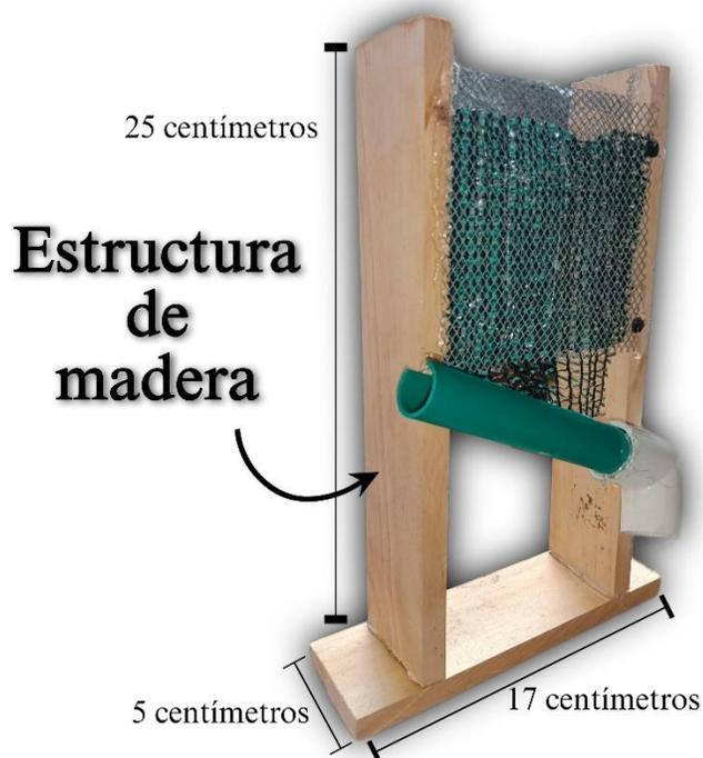
Este sistema está diseñado para operar tanto con la fuente electrostática conectada como sin ella, por lo cual se fabricó otra con las mismas dimensiones y características como se muestra en la Figura 7. Dado que incorpora todos los materiales y componentes necesarios para funcionar como un sistema de captación de agua casero convencional.
