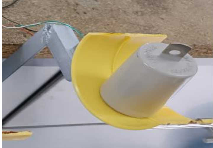
Figura 28. Calibración de la galga con un peso de 295 gramos
