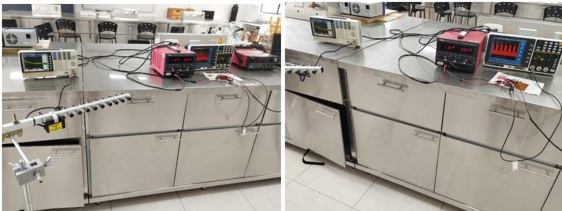
Figura 20 Circuito (Crystal-Controlled Am Transmitter) prototipo de sonda inalámbrica caracterización de sonda
