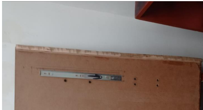
Figura 20. Instalación del marco de la plataforma.
