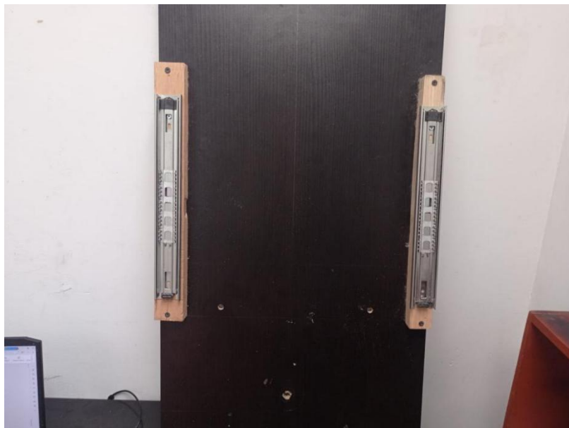
Figura 19. Instalación de los rieles sobre la base.
