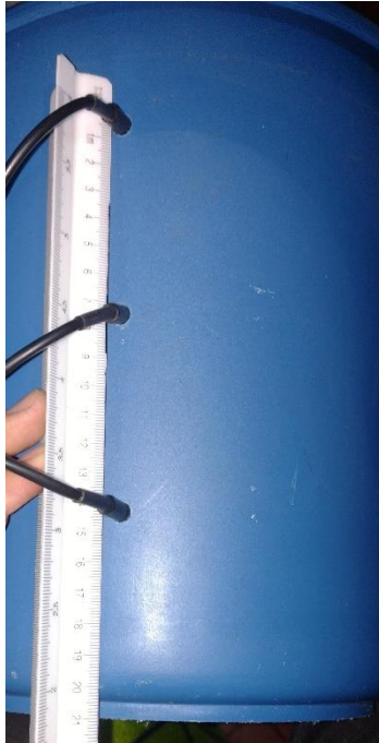
Figura 33 Ubicación de Sensores de Temperatura DS18B20
