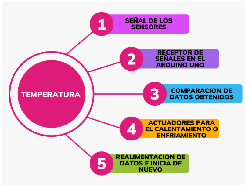
Figura 42 Diagrama organizacional de la interacción de la temperatura en el sistema de control
