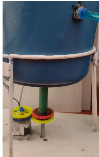
Figura 38 Motor Nema 17 acoplado con los engranajes
