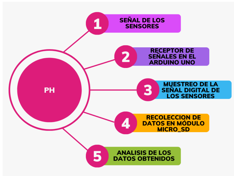
Figura 41 Diagrama organizacional de la interacción del pH para el comportamiento del café en el proceso de fermentación
