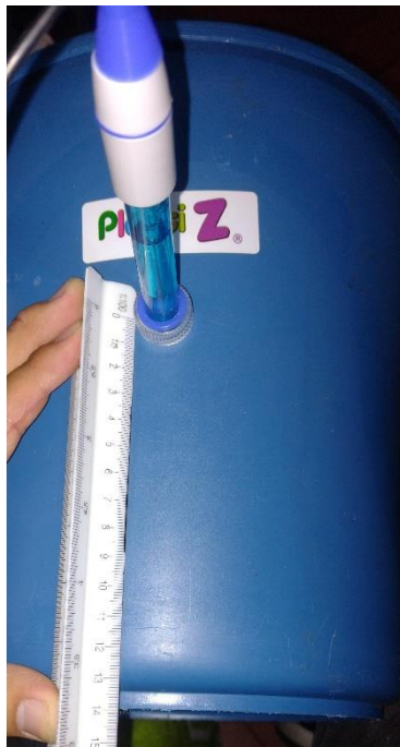
Figura 34 Ubicación de Sensor de pH de Arduino E201C
