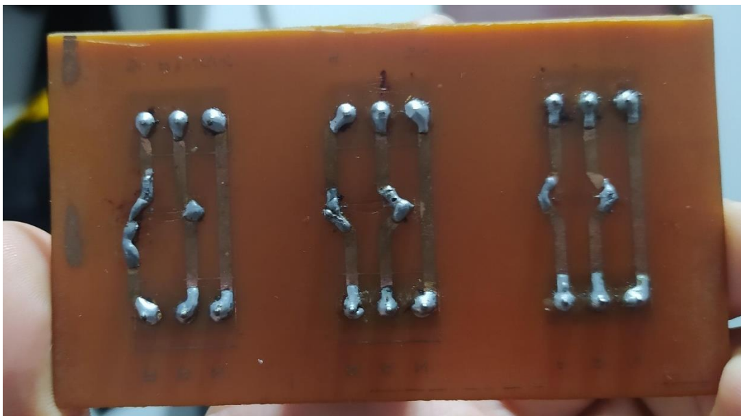
Figura 25 vista Posterior de los sensores DS18B20
