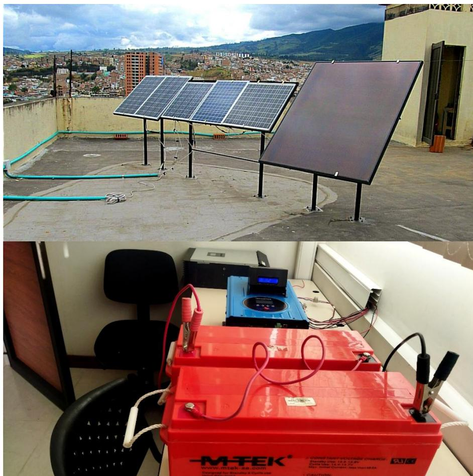
Fig. 51 Instalación experimental de módulos fotovoltaicos en área de pruebas físicas
