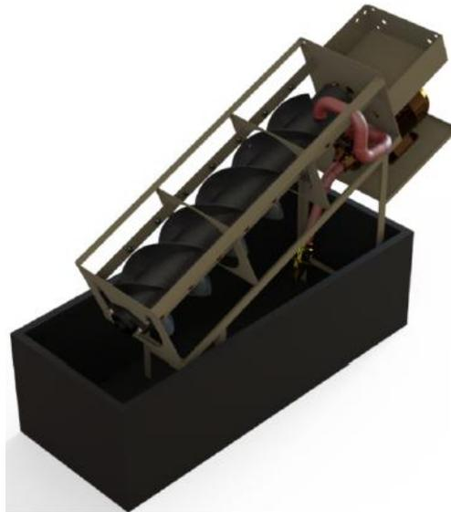
Fig. 1. Diseño renderizado del sistema de microgeneración.
