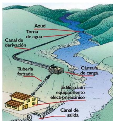
Fig. 16. Componentes de una central de agua fluyente
