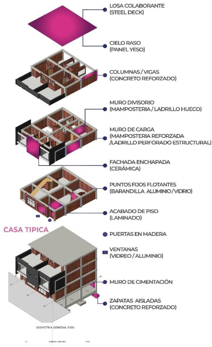
Figura 14. Isometría Arquitectónica – Vivienda Unifamiliar No Vis.
