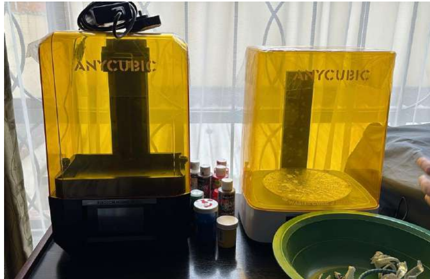
Figura 23. Impresora y máquina de curado Fuente: Elaboración Propia
