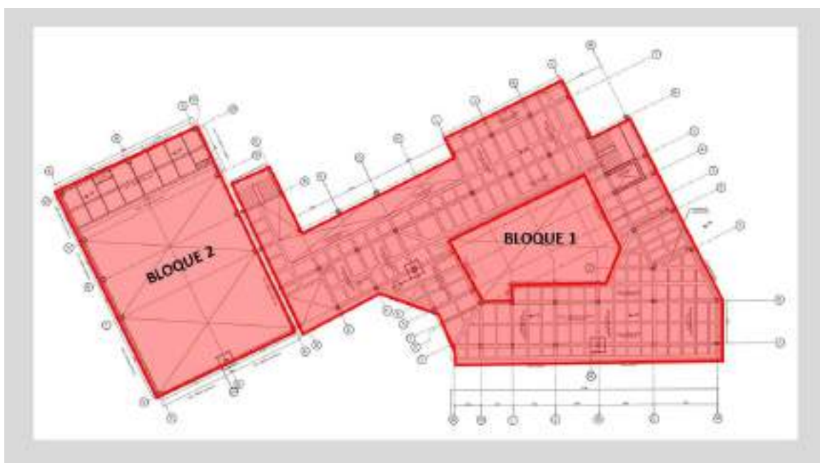
Figura 58. Plano. Nivel 2 planta estructural – ubicación de columnas
