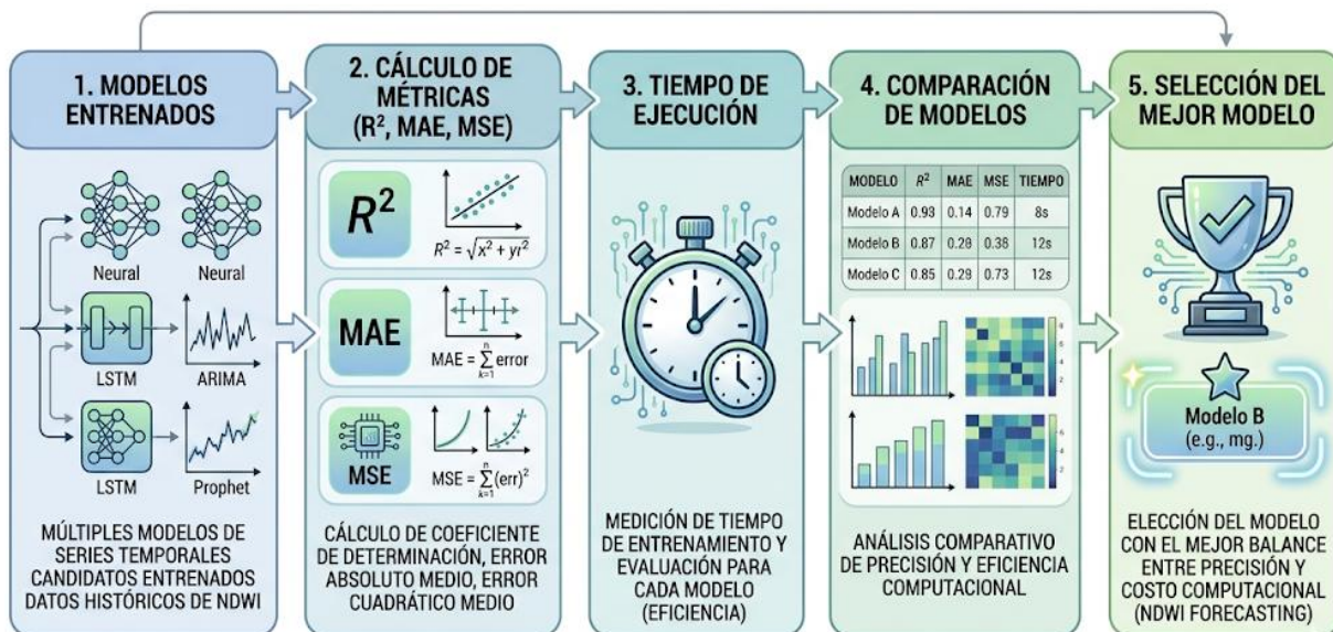
Fig. 17 Flujo de evaluación y selección de modelos de predicción del NDWI
