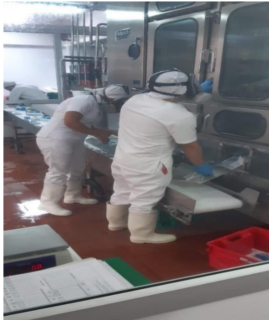
Figura 34. Inspección de sellado y peso
