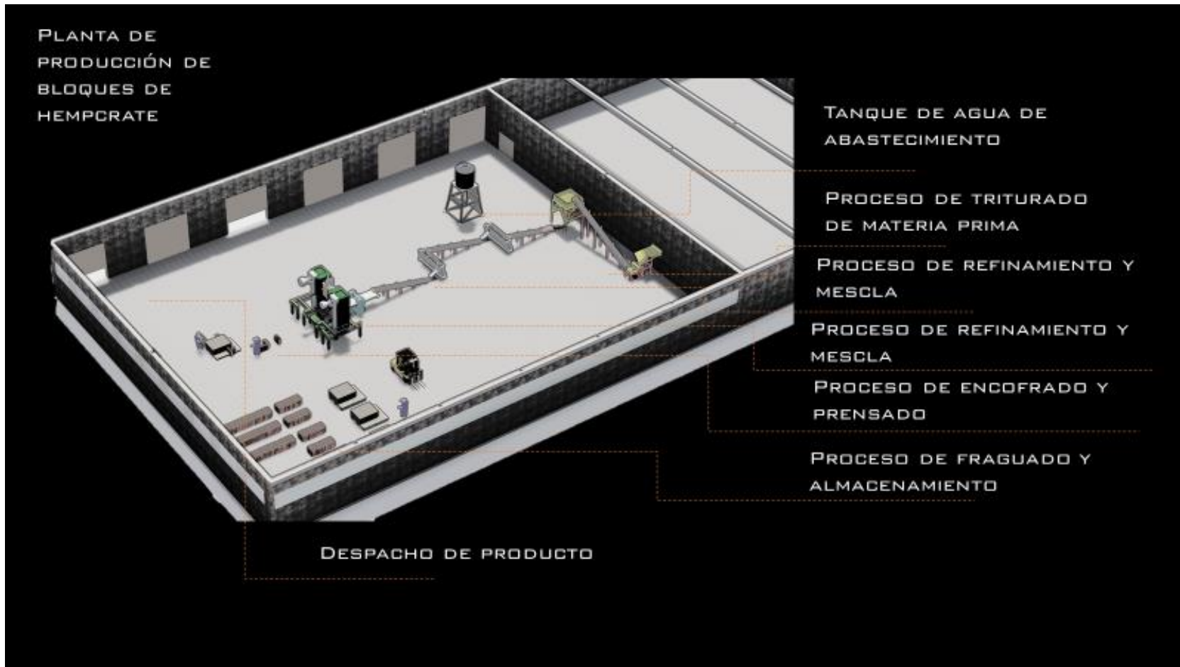
Figura 107. Vista general planta de producción de bloques .
