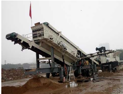
Figura 7. Planta de tratamiento y trituración.
