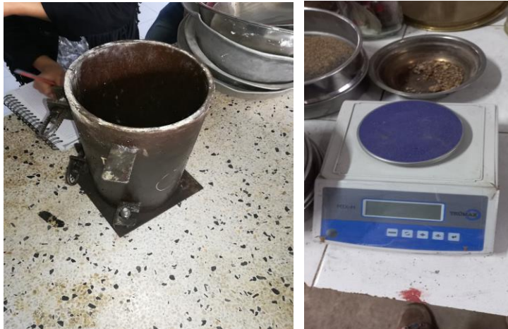
Figura 40. Equipo para ensayo de masa unitaria suelta y compacta de los RCD.
