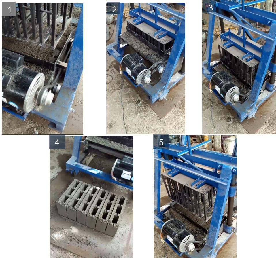
Figura 51. Elaboración de prefabricados con el 75% de RCD AGRE.H.A.
