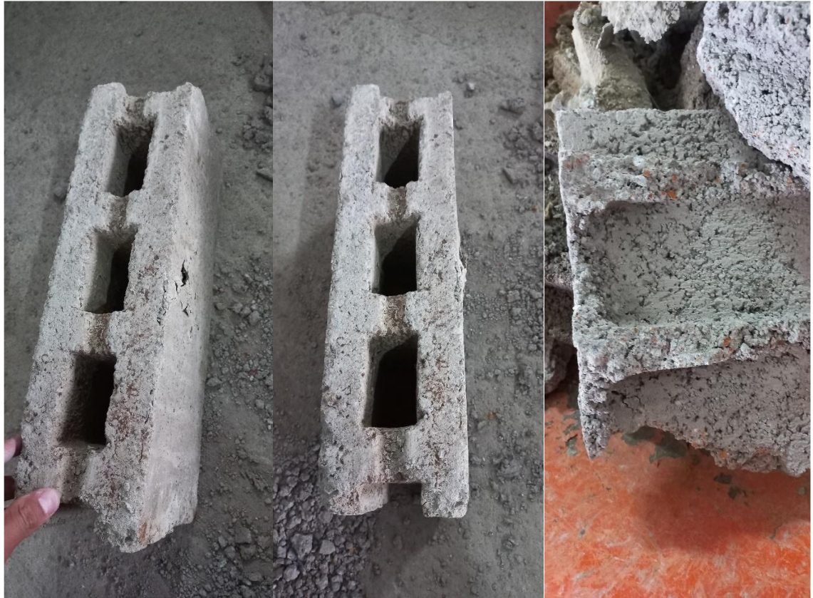
Figura 56. Unidad de mampostería luego de someterse a compresión.
