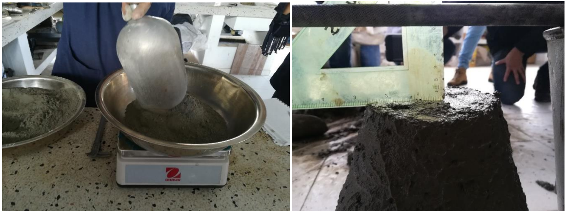
Figura 46. Equipo para ensayo de masa unitaria suelta y compacta de los RCD.
