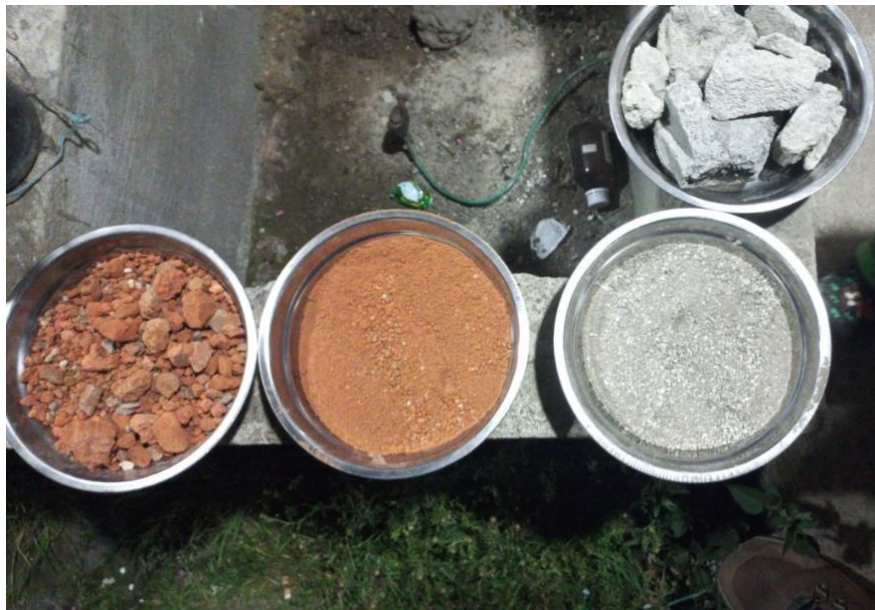
Figura 38. Materiales de RCD triturado de hormigón y ladrillo.
