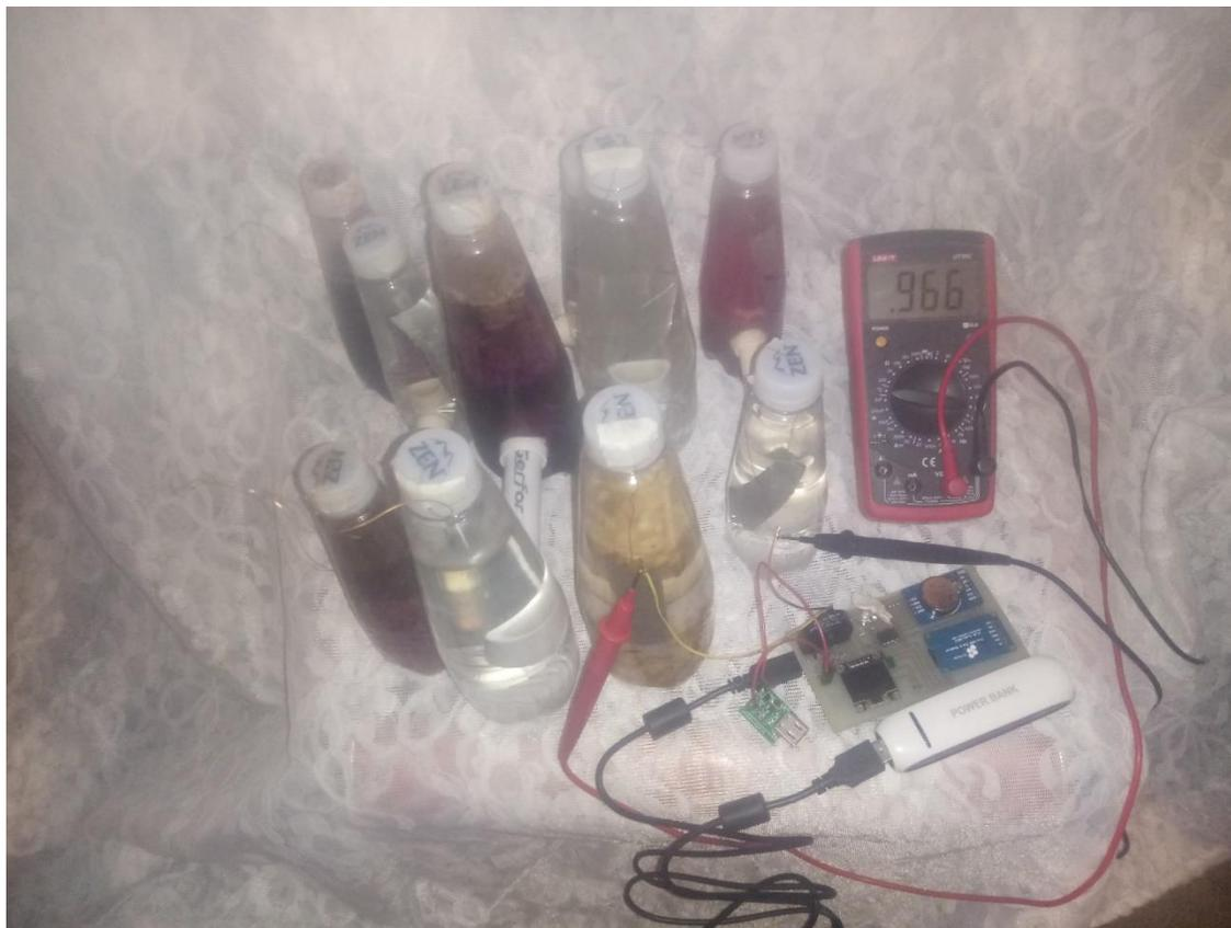
Nota. Sistema recuperador de energía conectado a las MFC para iniciar el proceso de recolección. Además, se conecta un multímetro directamente a las celdas configuradas en serie, teniendo un voltaje inicial de 0.966V que será comprobado por el circuito recuperador de energía.
