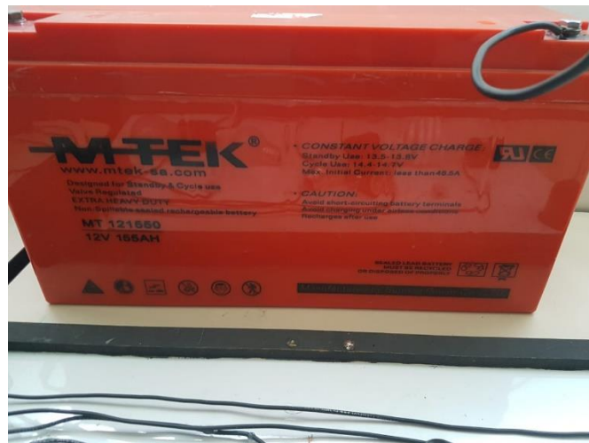
Figura 39. Condición inicial de la batería 13.5 v
