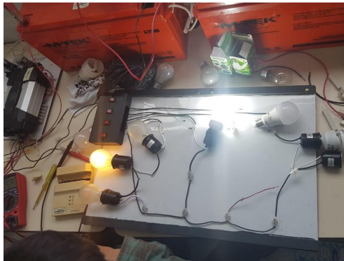
Figura 37. Montaje de los Sistemas Fotovoltaicos
