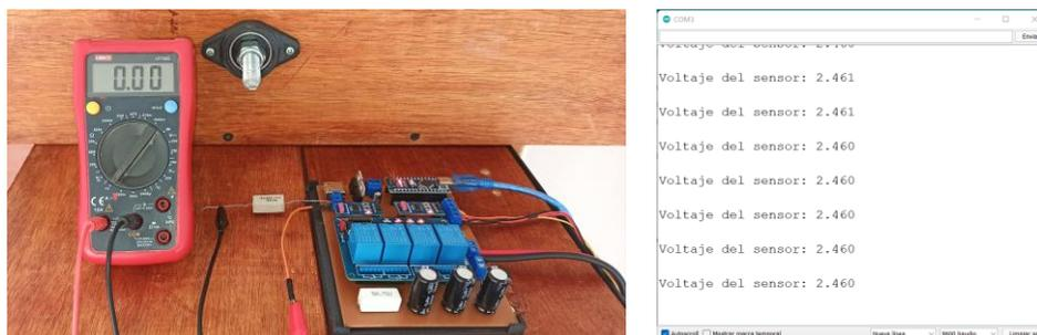
Figura 69. Voltaje de sensor para 0A
