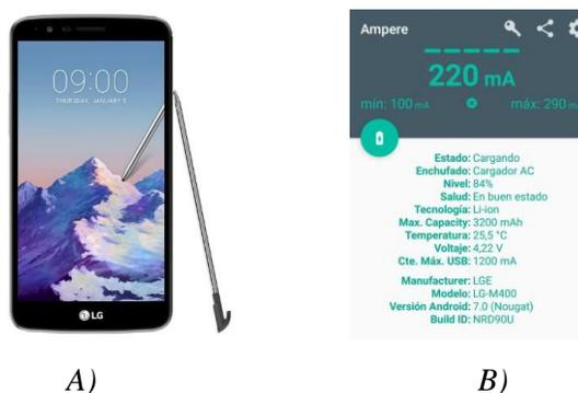
Figura 16. (A) Celular LG Stylus 3, (B) cálculo de consumo de corriente.
