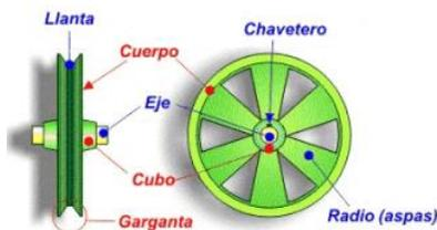
Figura 4. Partes de una polea.
