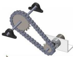
Figura 24. Acople mecánico del motor.
