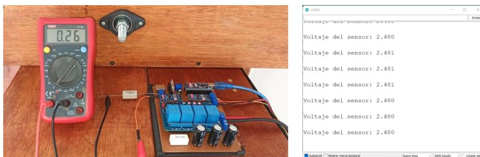
Figura 70. Voltaje de sensor para 0.26A.
