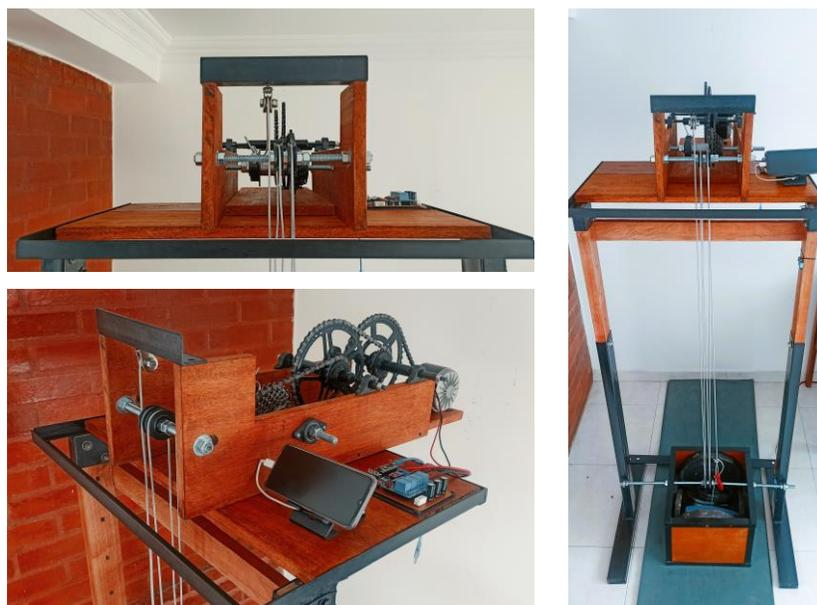
Figura 48. Batería por gravedad con motor generador MY1016 y sistema de poleas.
