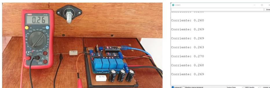
Figura 71. Medición de corriente con sensor ACS-712 (A3) vs multímetro.
