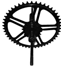
*Figura 57. Relación de transmisión piñón de 16 y corona de 48 dientes a eje de 8mm.*
