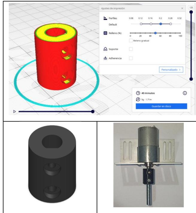
Figura 58. Acople rígido de 6mm (eje motor) a 8mm.
