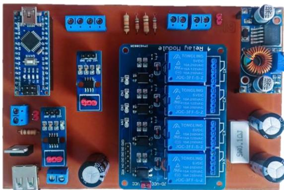
Figura 56. Placa de circuito impreso con modulo convertidor de voltaje XL4005.
