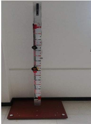
Figura 19. Montaje convencional para Caída libre
