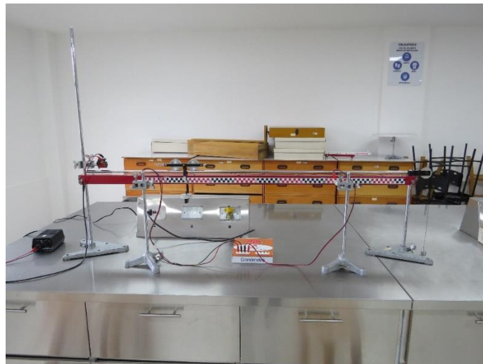
Figura 3. Montaje convencional del sistema carril de Fletcher
