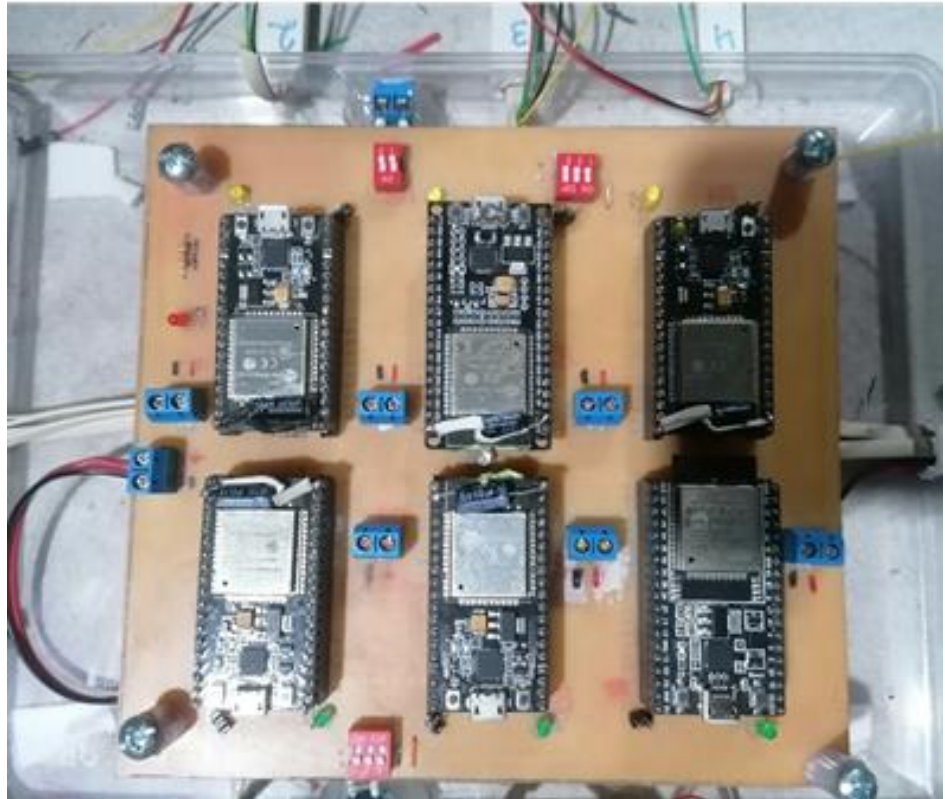
Figura 10. Placa del sistema de control de iluminación
