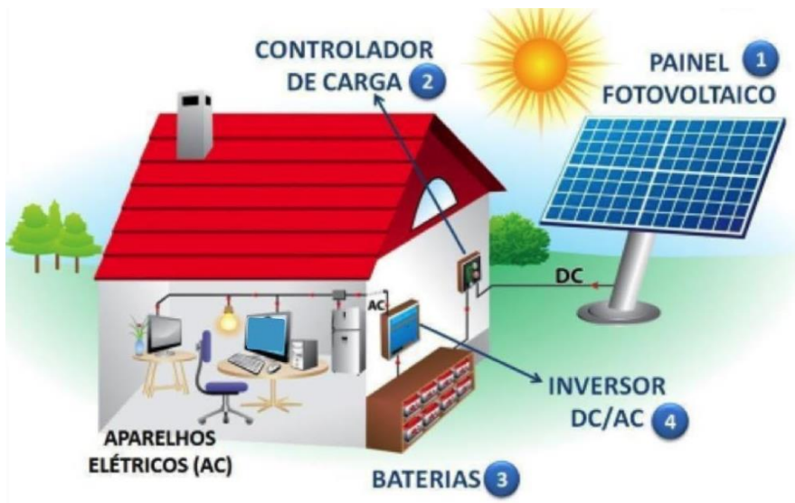
Figura 2. Sistema solar fotovoltaico, Google imágenes
