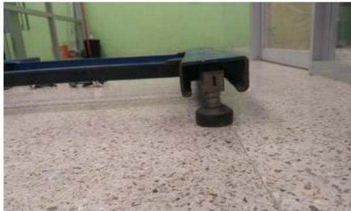
Figura 1. Celdas de carga adaptadas a una viga metálica.
