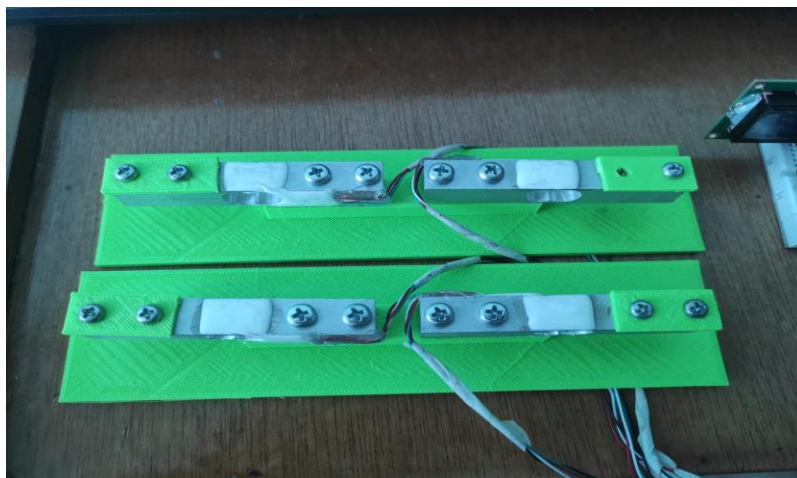
Figura 20. Acople de galgas en la estructura 3D.
