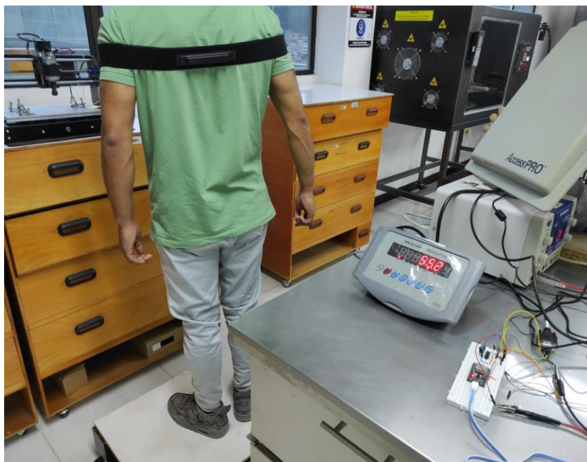
Figura 27. Conexión lectora RFID, barras ganaderas con circuito y ESP 32.
