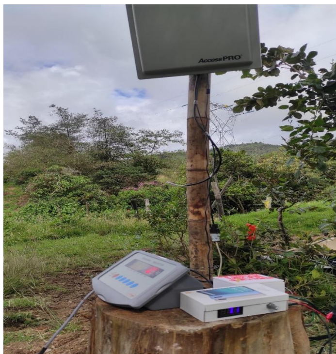
Figura 47. Implementación antena RFID con circuito y monitor de pesaje.
