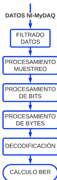
*Figura 23 Diagrama de Bloques etapa de adquisición de datos en la recepción.*
