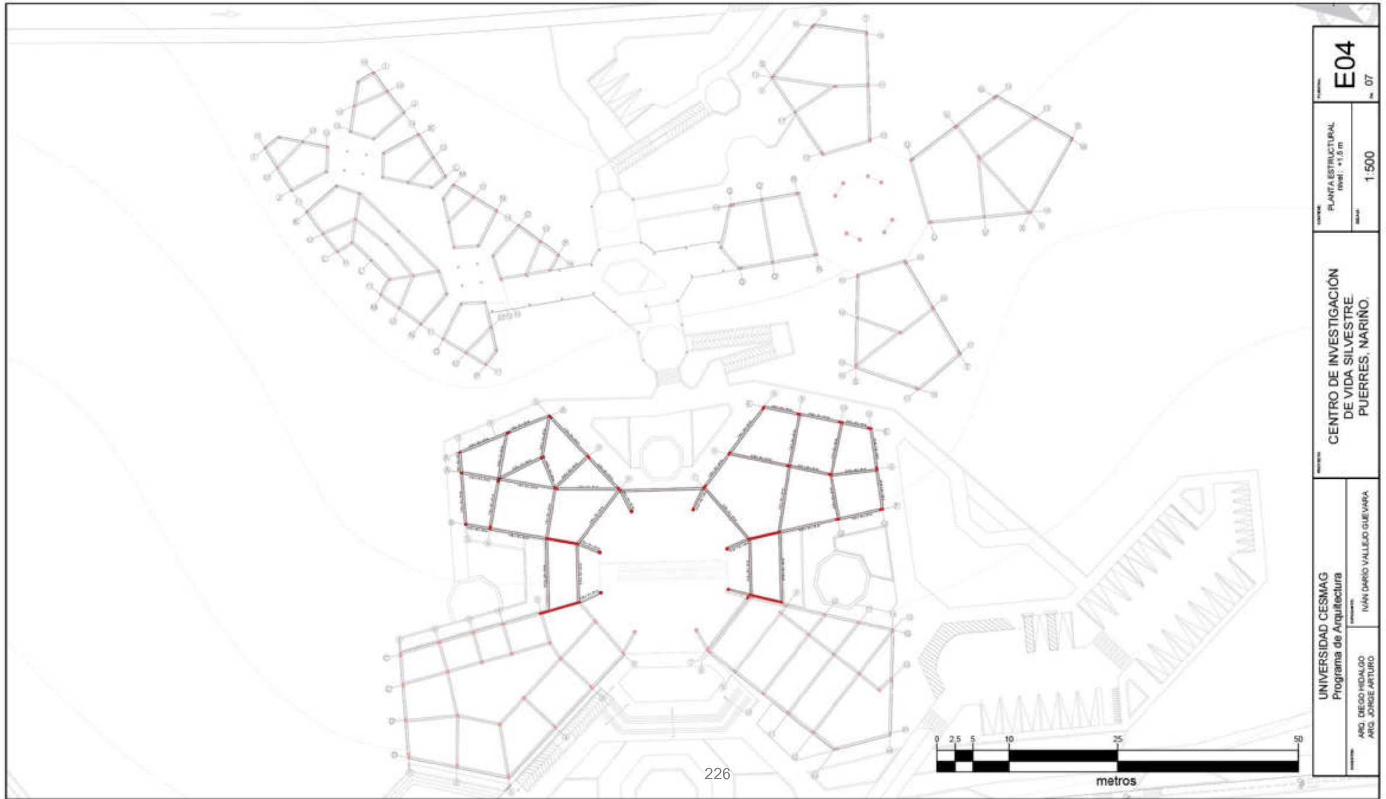
Anexo 30. Planos Estructurales Planta Estructural Nivel +1.5 m
