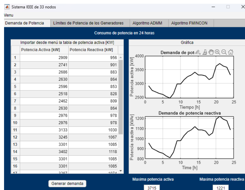
Figura 26. Perfil de demanda de potencia red IEEE de 33 nodos
