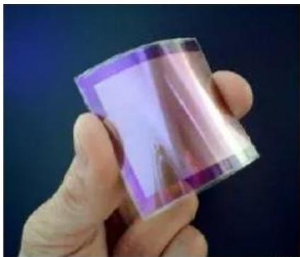
*figura 9. Celda Fotovoltaica de Silicio amorfa*
