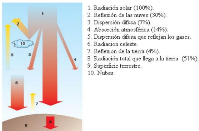
*figura 19. Radiación solar absorbida y reflejada por la superficie terrestre*
