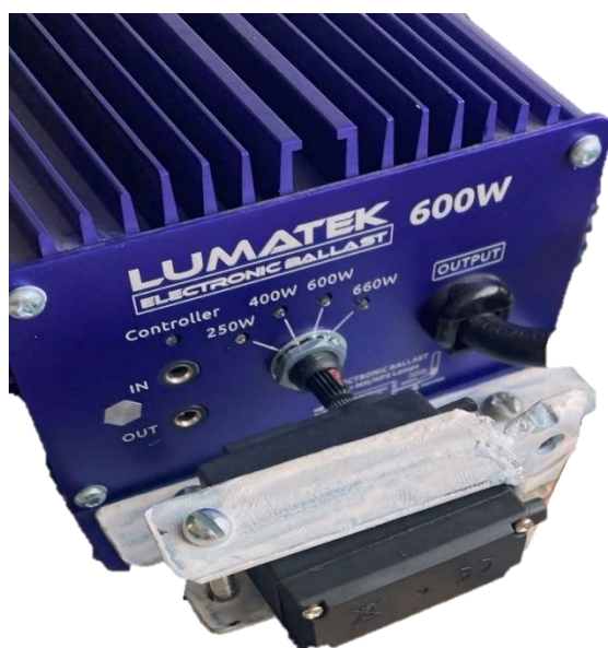
Figura 33. Montaje del servomotor con el balasto para ajuste de irradiancia
