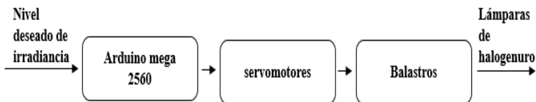
Figura 32. Diagrama de bloques control de irradiancia
