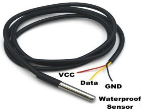
Figura 14. Sensor de temperatura ds18b20
