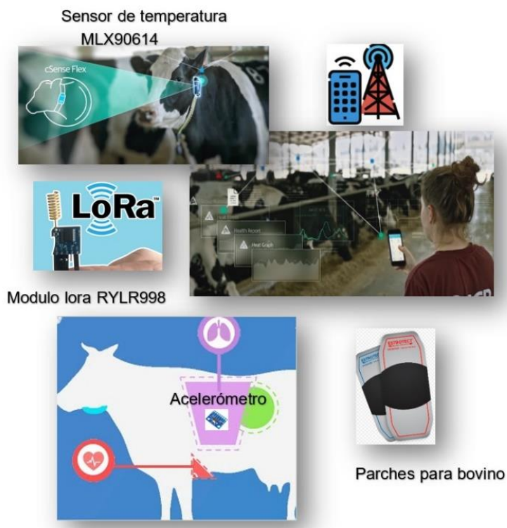
Figura 4. Sistema de monitoreo de temperatura y frecuencia respiratoria para bovinos
