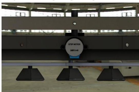
Figura 21. Motor paso a paso acoplado al rastrillo
