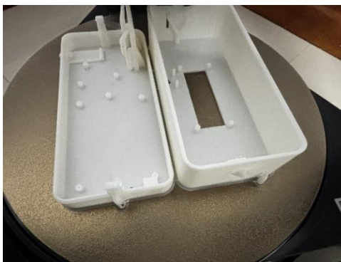
Figura 43. Impresión en 3D carcasa
