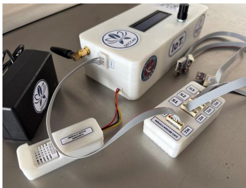
Figura 44. Ensamblaje completo dispositivo IoT
