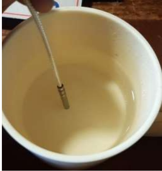
Figura 50. Inmersión en agua calentada progresivamente
