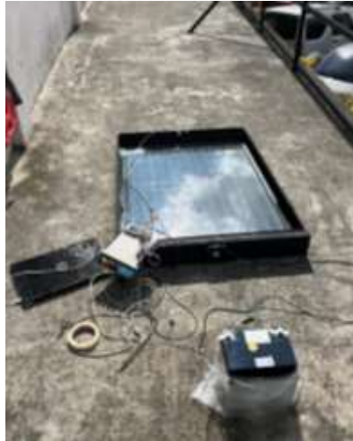
Figura 42. Montaje experimental del colector solar durante las pruebas de funcionamiento
