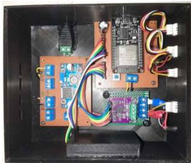
Figura 36. Módulos y placas en caja impresión 3d
