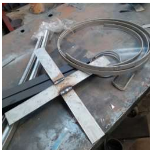
Figura 9. Fabricación de la cruzeta estructural del tambor
