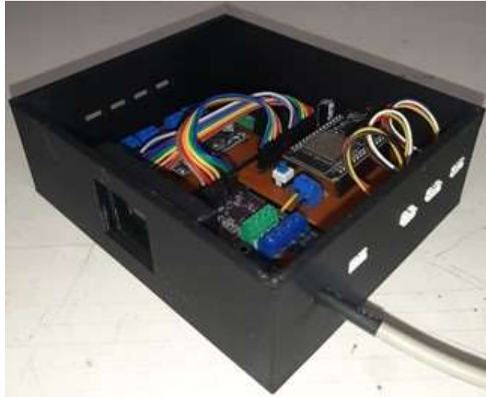
Figura 35. Montaje placas de potencia y control en caja en impresión 3d
