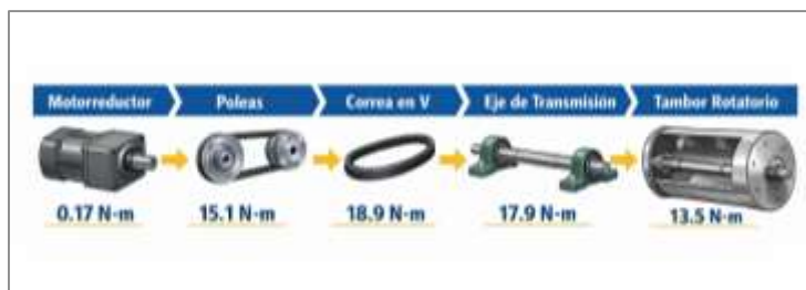
Figura 6. Diagrama del flujo de torque en el sistema de accionamiento del tambor rotatorio
