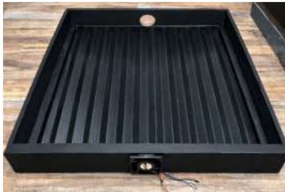
Figura 14. Base con lamina de zinc pintados de negro mas el ventilador
