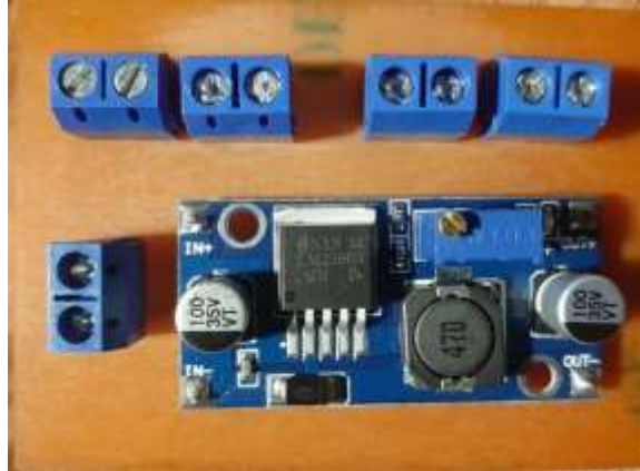
Figura 33. Montaje lm2596 en placa de potencia
