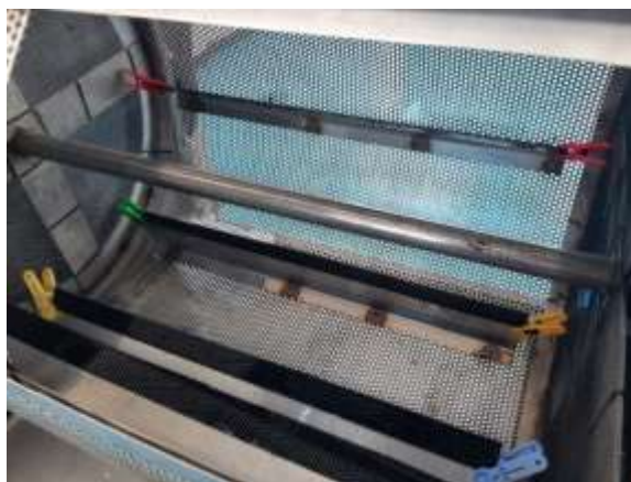
Figura 10. Instalación de las aletas internas
