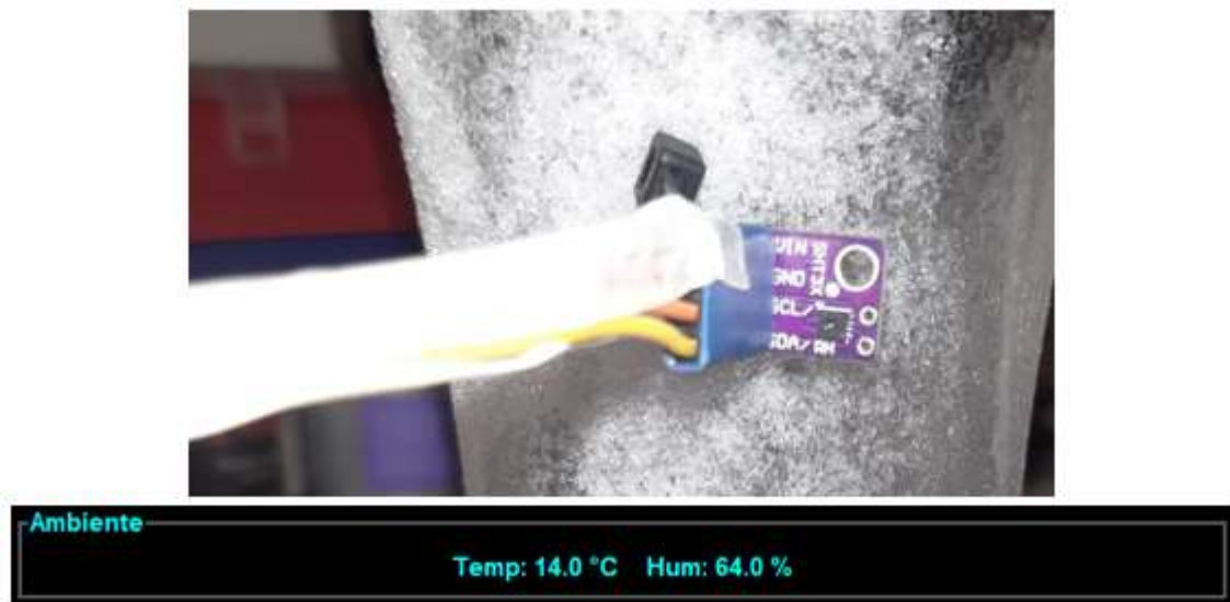
Figura 56. Respuesta sensor SHT31-2 a prueba de hielo
