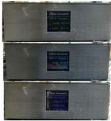
Figura 57. Visualización correcta de los datos de los sensores en la pantalla TFT
