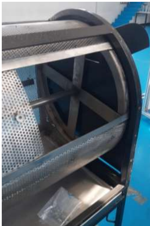
Figura 11. Integración del tambor con la estructura
