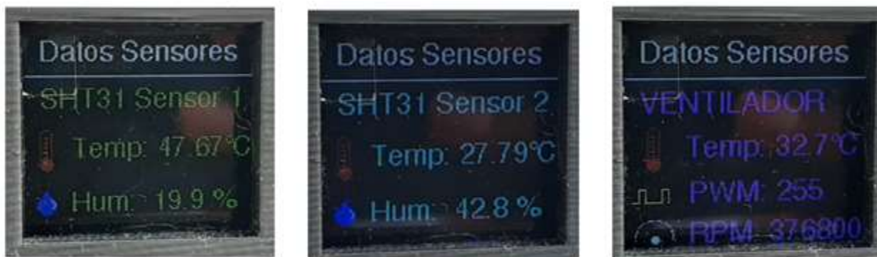
Figura 37. Visualización de los datos en pantalla tft código esp32
