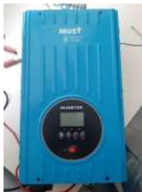
Figura 100. Inversor utilizado en el sistema fotovoltaico
