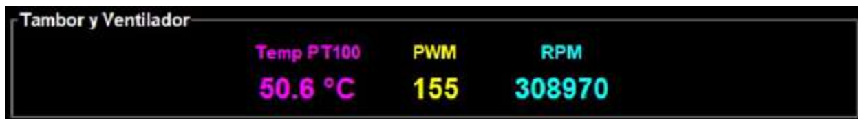
Figura 59. PWM cuando temperatura PT100 está en 50°C calculado con PID
