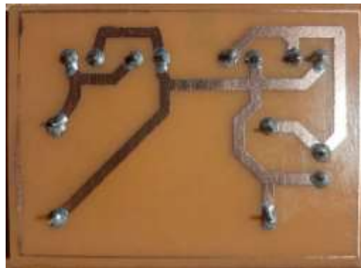
Figura 32. Circuito de potencia en baquelita
