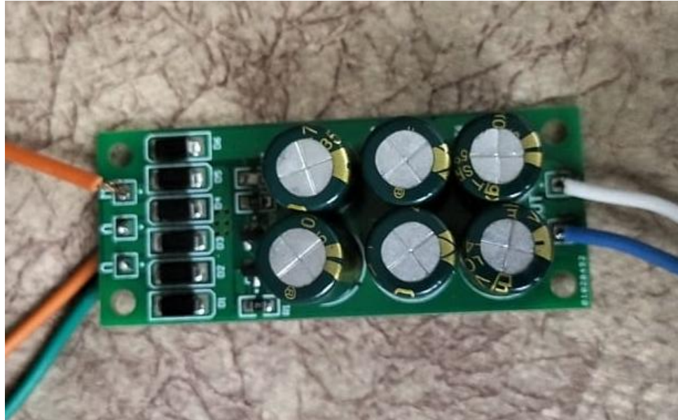
Figura 15. Rectificador trifásico instalado
