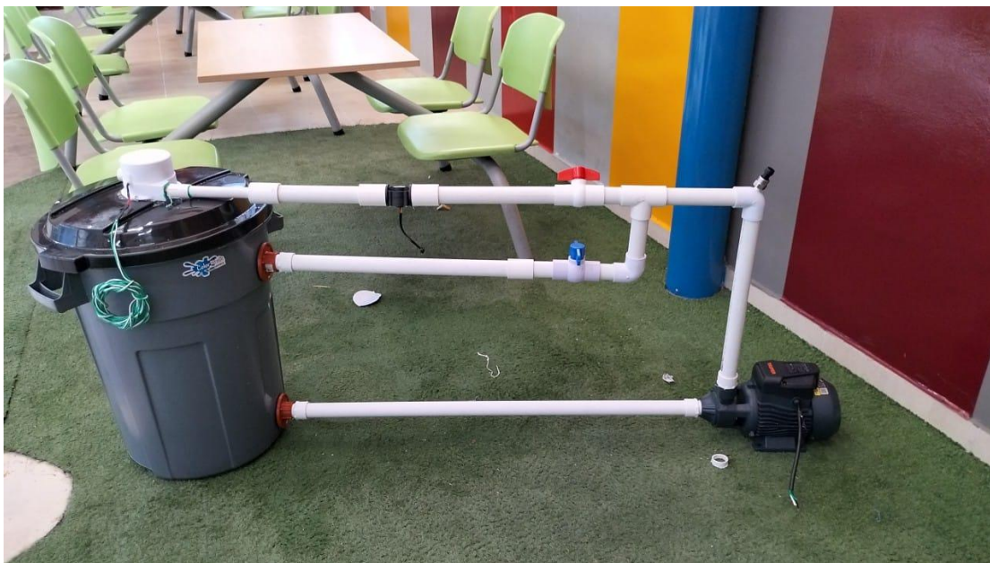
Figura 8. Primera versión del sistema hidroeléctrico
