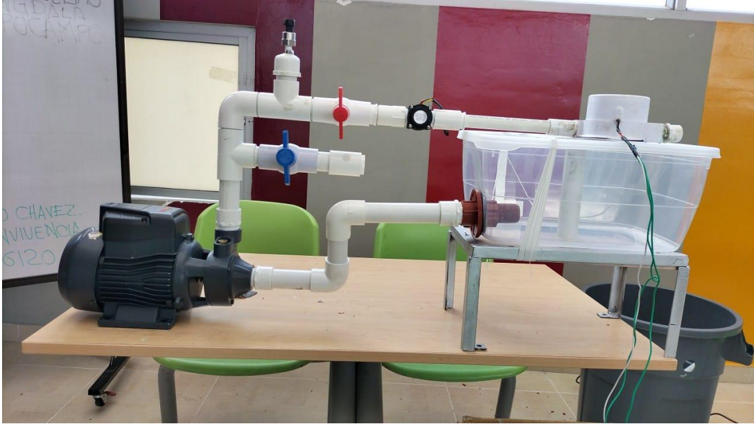
Figura 9. Implementación de Versión final del sistema hidroeléctrico
