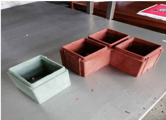
Figura 2. UniPlock y ElePlock, elementos para la construcción de edificaciones.
