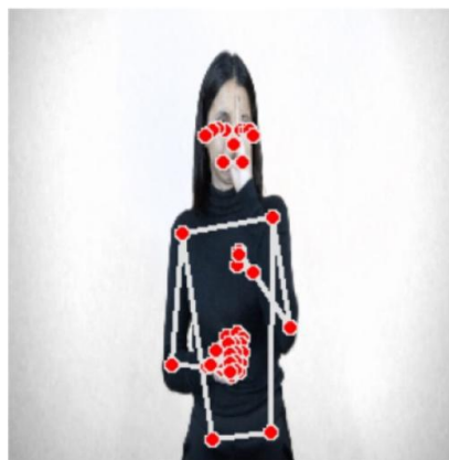
Fig. 9 Representación basada en extracción de puntos clave
