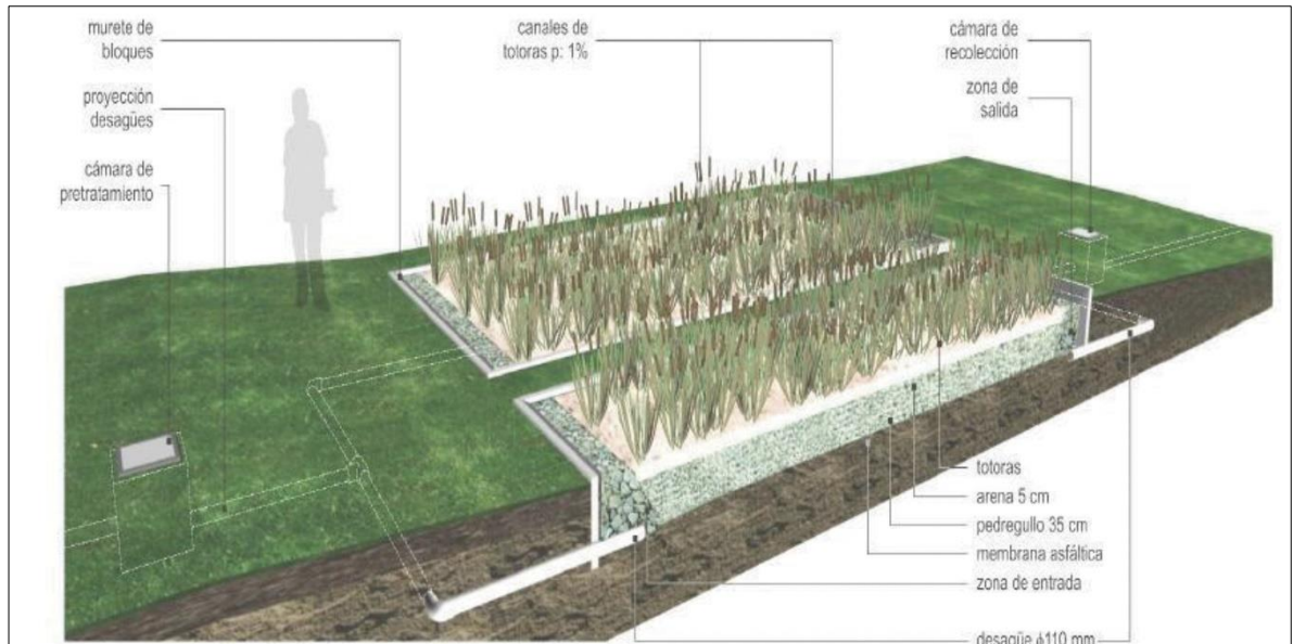
Figura 16. Esquema de propuesta funcionamiento humedales
