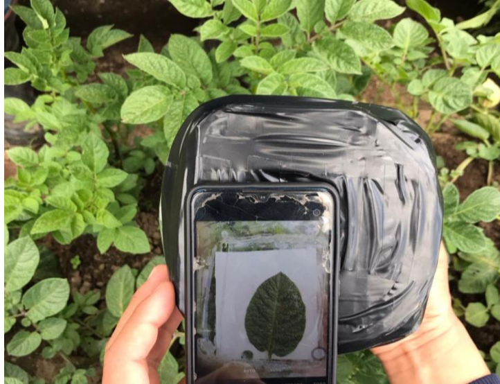
Figura 11. Toma de datos. Muestra el dispositivo en la toma de datos registrando una hoja
