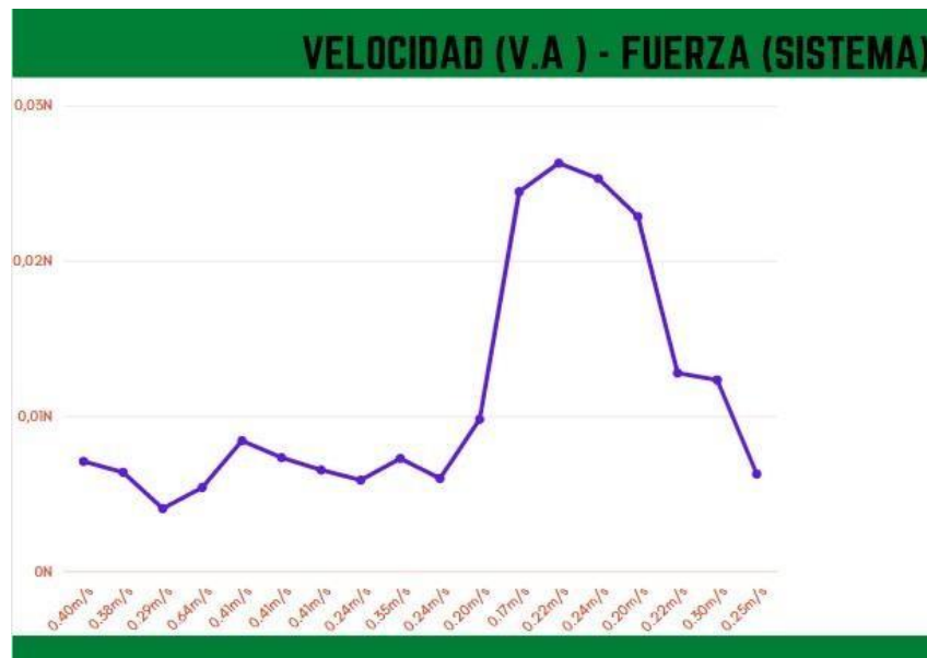
Figura 72. Relaciones de la velocidad calculada a través de visión artificial y la fuerza calculada a través del sistema.
