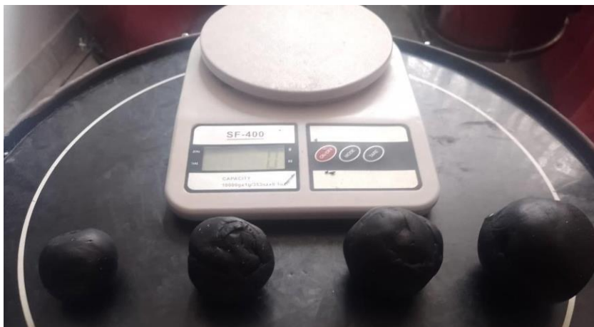
Figura 18. Pesos de caracterización de sensores piezoeléctricos.
