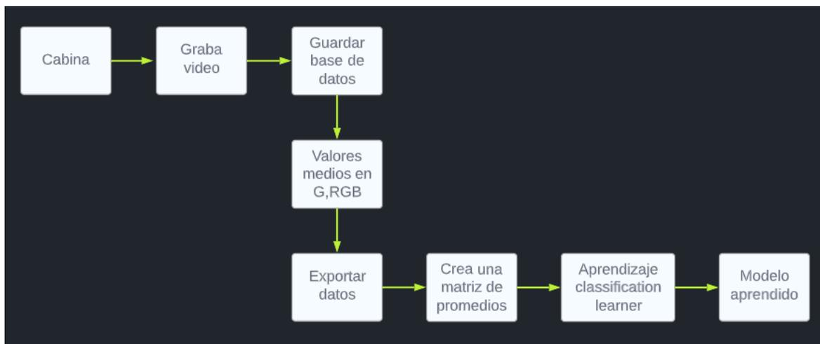
Figura 22. Diagrama de bloques imágenes hiperespectrales y aprendizaje automático.
