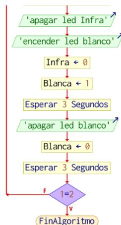
Figura 11. Diagrama de flujo de programación leds.
